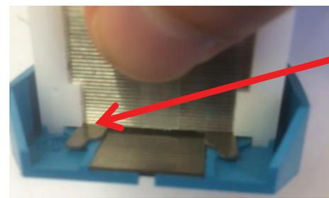
Si las partes metálicas no son visibles, empujarlas hacia delante con cualquier herramienta estrecha
