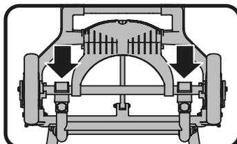
Encaje la barra transversal en ambos soportes de rueda
