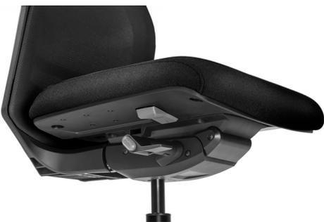
Dispone de un desplazador de asiento que actúa independientemente del mecanismo, con 5 diferentes posiciones para adaptar la profundidad de la posición sedente y un recorrido de 6 cm.
