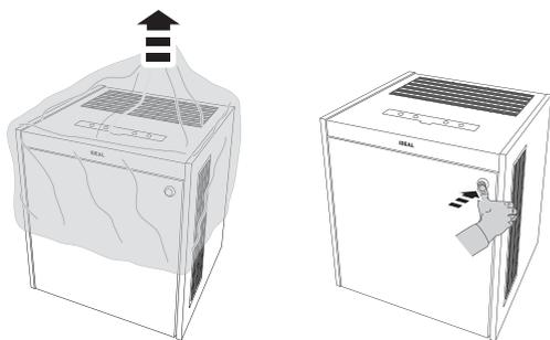
Retirar la lámina de protección. Desbloquear la puerta presionando el cierre de presión; aparecerá el pomo de la puerta.
