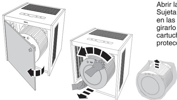
Abrir la puerta con el pomo. Sujetar el cartucho filtrante con las dos manos en las hendiduras previstas para ello y girarlo en sentido antihorario. Extraer el cartucho filtrante y retirar la lámina de protección.
