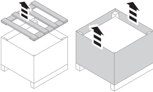
Abrir la lámina de protección de la base y descubrir completamente las ruedas. Extraer la caja con los accesorios. Sacar el cable de red, el mando a distancia (con la lámina magnética autoadhesiva) y el manual de instrucciones
